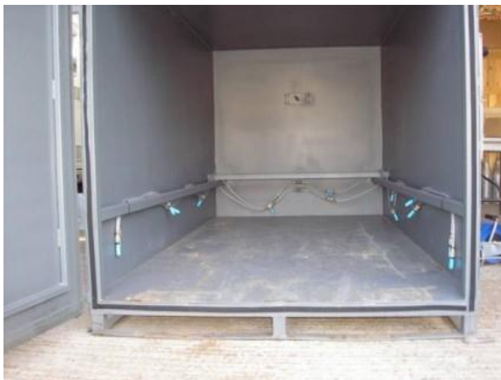
Imagen 4. Cámara de gas para aturdimiento de aves con CO2
